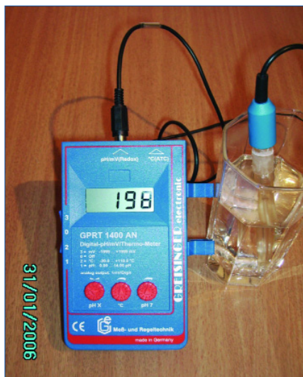
Abb. 1: Redoxpotenzialmessung von Leitungswasser (Ag/AgCl-Werte)
